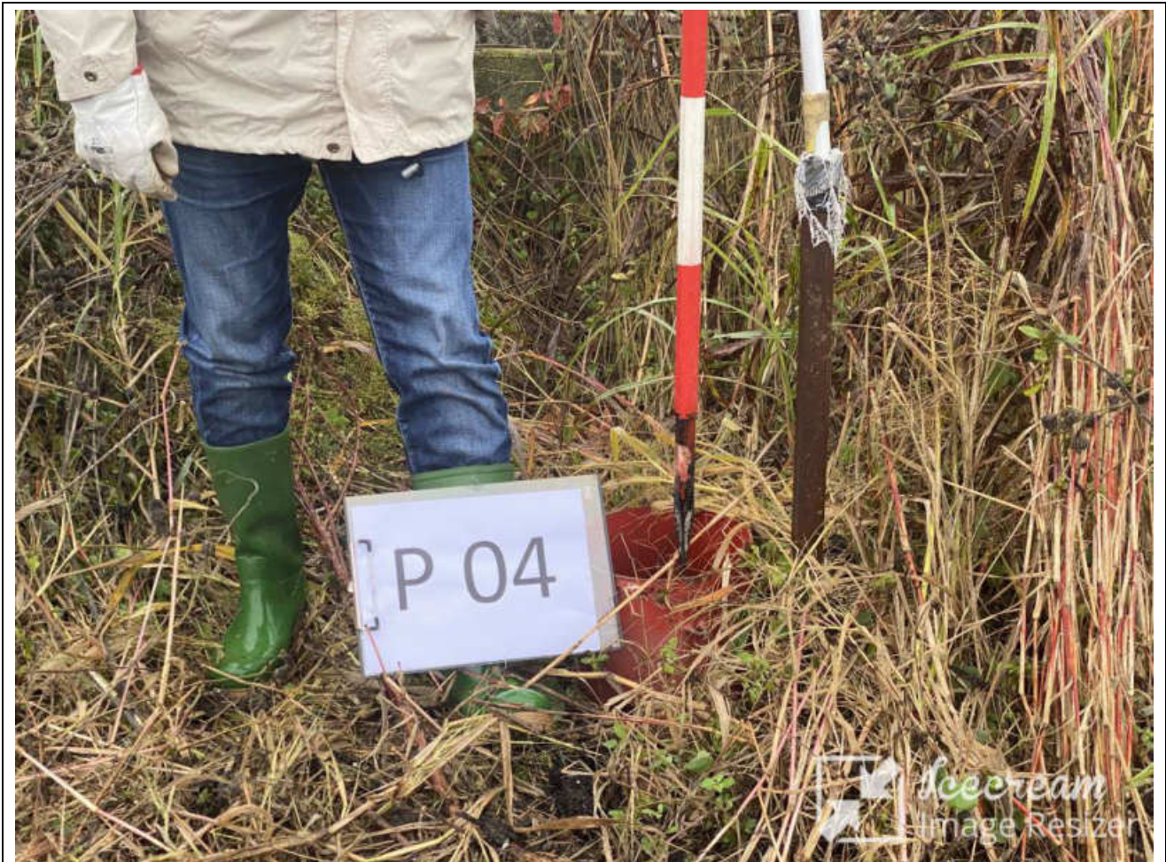
Fotografia Piezometro P 04.
