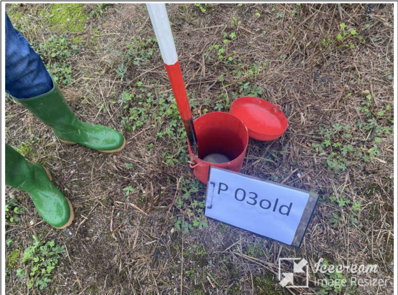
Fotografia Piezometro P 03 Old.
